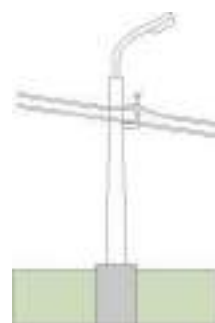
Самонесущий изолированный провод (СИП): силовая опора
