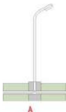
Подземная прокладка: несиловая опора
