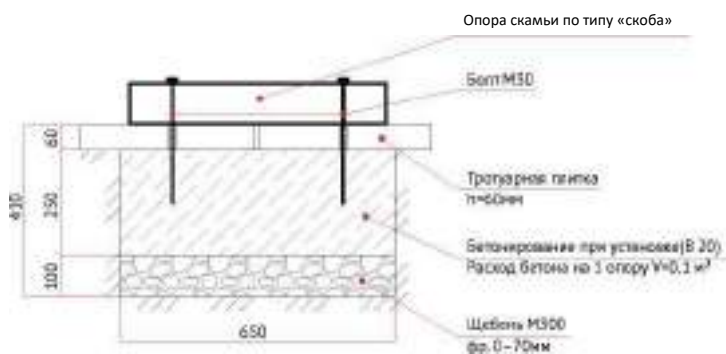
Узел 16. Схема бетонирования фундамента скамьи
