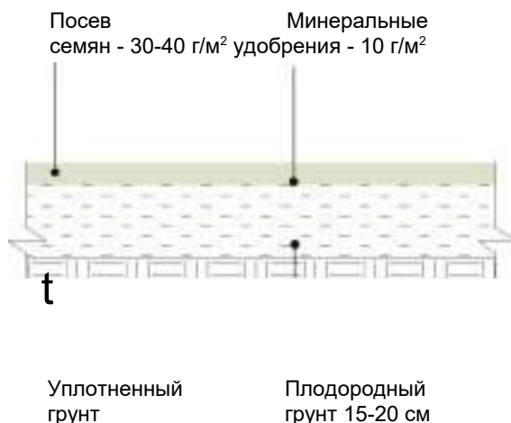
СХЕМА УСТРОЙСТВА ПОСЕВНОГО ГАЗОНА
